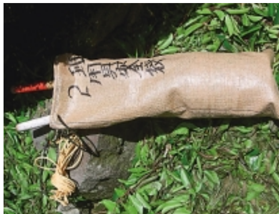
▲各班に備えている「用具安全袋」 中は塩ビ管、底は発砲スチロールを使用。 コンバイン袋をもらい受けて作成した。 オレンジ色の紐で上まで引き上げる。
